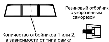
Установка резинового отбойника на калитку
