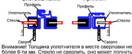
Сверловка бокового профиля для крепления упорных стоек - рамка Элит Система петли
